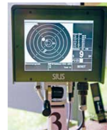
Heutige moderne elektronische Trefferanzeigen der Firmen Polytronic, SIUS und Meyton. Sie alle haben eine sehr genaue Trefferanzeige, die im Millimeterbereich die Schüsse anzeigt.
